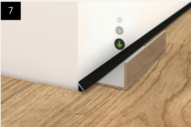
Sobald der Spannvorgang abgeschlossen ist, wird das Abschlussprofil nach unten gedrückt und die Montagehilfe abgezogen. Nun wiederholt sich der Spann- und Montagevorgang, bis alle Montageclips eines Abschlussprofils gespannt und versenkt sind. Zu evtl. Korrekturen kann das Abschlussprofil jederzeit aus der Anschlussfuge entnommen werden.
