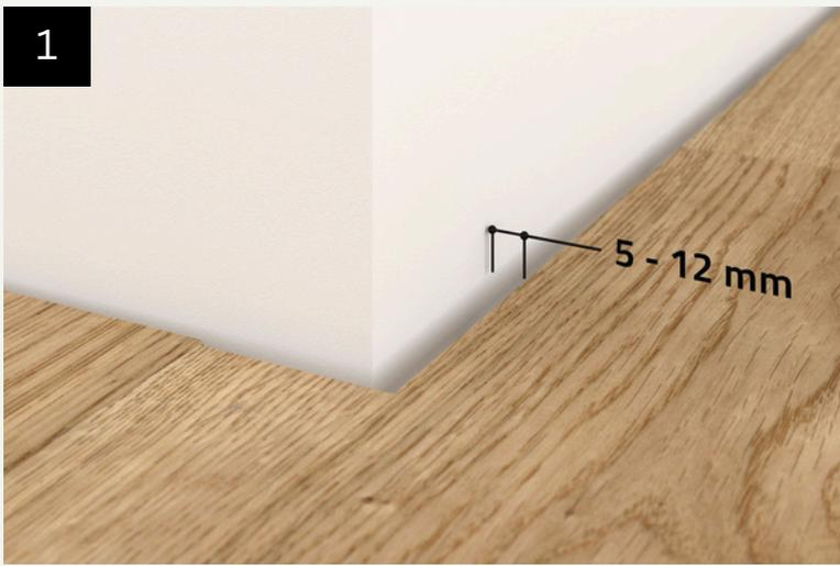
Die Breite der Anschlussfuge sollte je nach verwendetem Abschlussystem zwischen 5 und 12 mm sein. Ebenfalls zu berücksichtigen ist die Stärke des Bodenbelags. Die Systeme des Typs X5 können bereits ab einer minimalen Bodenbelagsstärke von 5 mm eingesetzt werden.
